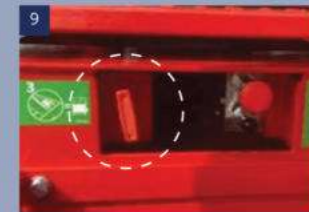
9 วาล์วลดระดับแบบแมนนวล: เมื่อระบบการทำงานล้มเหลวหรือพลังงานแบตเตอรี่เหลือน้อยเกินไป จนทำให้แท่นไม่ลดระดับลง เราสามารถใช้วาล์วนี้เพื่อลดระดับเครื่องลงได้
