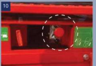
10 วาล์วปล่อยแรงด้วยมือ: เมื่อเครื่องไม่สามารถเคลื่อนที่ได้ คุณสามารถดันเครื่องได้หลังจากควาล์วนี้
