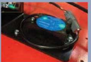
12 เซ็นเซอร์วัดมุม: เมื่อเครื่องกำลังยกหรือเคลื่อนที่บนทางลาด เซ็นเซอร์จะตรวจสอบสถานะของเครื่องโดยอัตโนมัติ หากมุมเอียงมากกว่ามุมที่กำหนดไว้ เครื่องจะส่งสัญญาณเตือนไปยังผู้ปฏิบัติงาน
